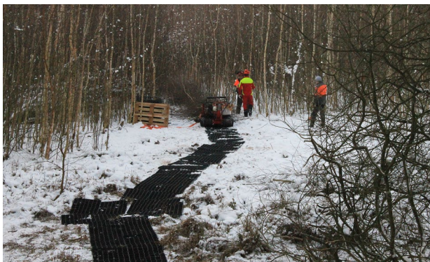
Abb. 7: Gummimatten zur Verwendung eines eisernen Pferdes.
